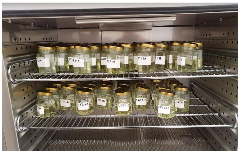
Figur 6 Akselerert lagringsforsøk av oljeprøver i varmeskap
